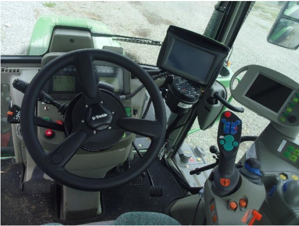
図5 自動操舵装置（モータ内蔵タイプ）
