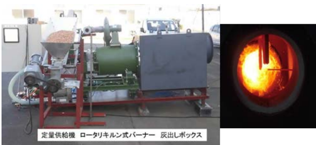
図5 ロータリーキルン式バーナー(10万 kcal/時) 燃焼温度を 800~1100℃で制御
