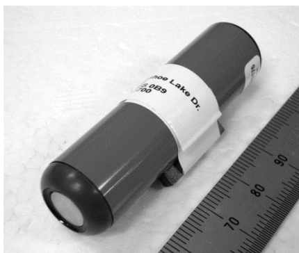
図7 ウナギの放流・追跡に用いた超音波発信機（ピンガー）（直径 1.5cm、長さ 5.5cm、水中重量 9gr）
